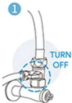
關閉 水源進水
